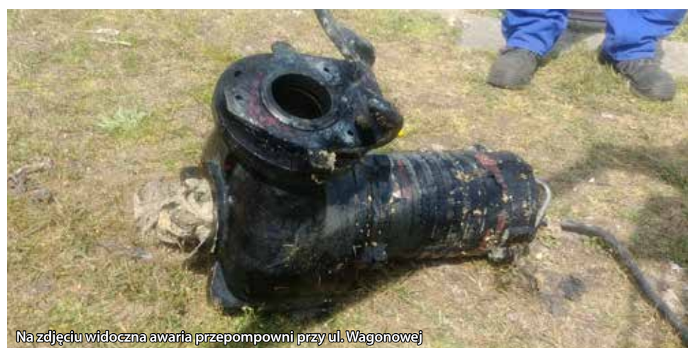
Pompa została zablokowana przez zalegające w kanalizacji maseczki
